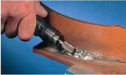
Fresa cilíndrica redonda.
