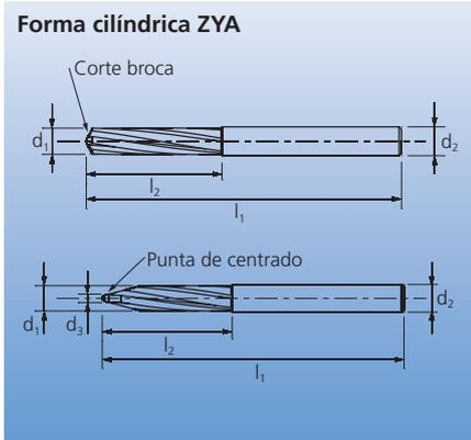
Fresa forma cilíndrica.
