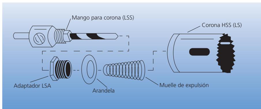
PFERD ofrece un sistema de fijación para un rápido y fácil uso de coronas HSS. El sistema de fijación rápida y los dos juegos de adaptadores de tres piezas que se adaptan al diámetro de las coronas permiten utilizar las coronas HSS de PFERD de manera sencilla y confortable con todas las máquinas convencionales.
