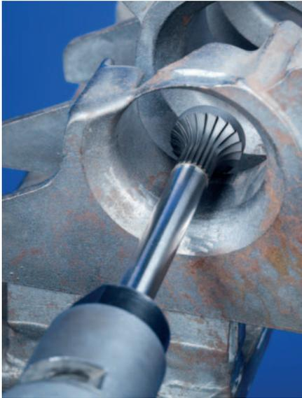
Fresa para radios con forma cóncava y dentado especial, suministrable en dos ejecuciones:
