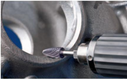
Fresa forma árbol DIN 8032 con dentado según DIN 8033.
