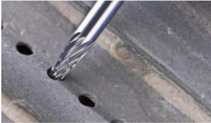
Fresa cónica apuntada según DIN 8032 y dentado según DIN 8033. Punta achatada.
