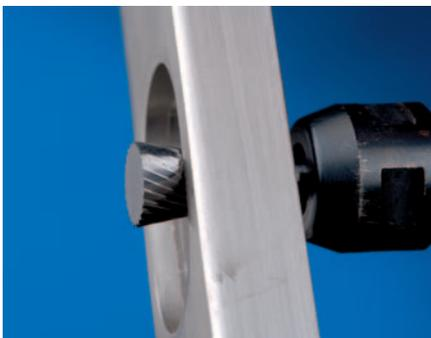
Fresa cónica plana que se va estrechando en el sentido del mango, según DIN 8032 con dentado según DIN 8033. Forma WKNS con dentado frontal.
