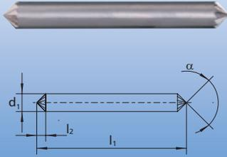
Fresa en forma de avellanador cónico según DIN 8032 y dentado según DIN 8033 con ángulo (90°). La ejecución KSK 0603/6 (doble punta) tiene ambas caras dentadas y útiles (ver figura).
