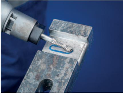
Fresas en cuatro formas especiales con mango de 6 mm. Las distintas formas disponibles permiten adaptarse mejor a diferentes tipos de fresado.
