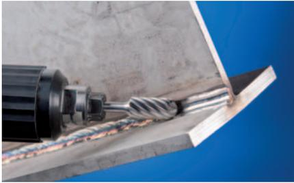
Fresa forma redonda cilíndrica según DIN 8032. Combina las geometrías cilíndrica y esférica.
