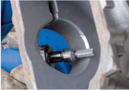
Fresa forma cilíndrica según DIN 8032.
