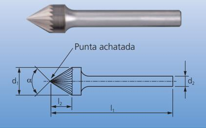
Fresa cónica según DIN 8032 y dentado según DIN 8033 con ángulo en punta (60°). La ejecución KSJ 0605/6 (doble punta) tiene ambas caras dentadas y útiles (ver figura).
