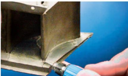
Fresa esférica según DIN 8032 con dentado según DIN 8033.
