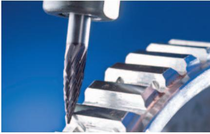
Fresa forma obús según DIN 8032 con dentado según DIN 8033, punta achatada.
